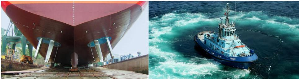
FIGURE 1.21 – Illustrations du système Voith-Schneider
