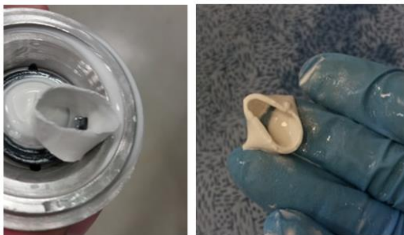
Figure 158. Photographies des couches fortement résistantes, causées par la dispersion par un super plastifiant (Glenium)
