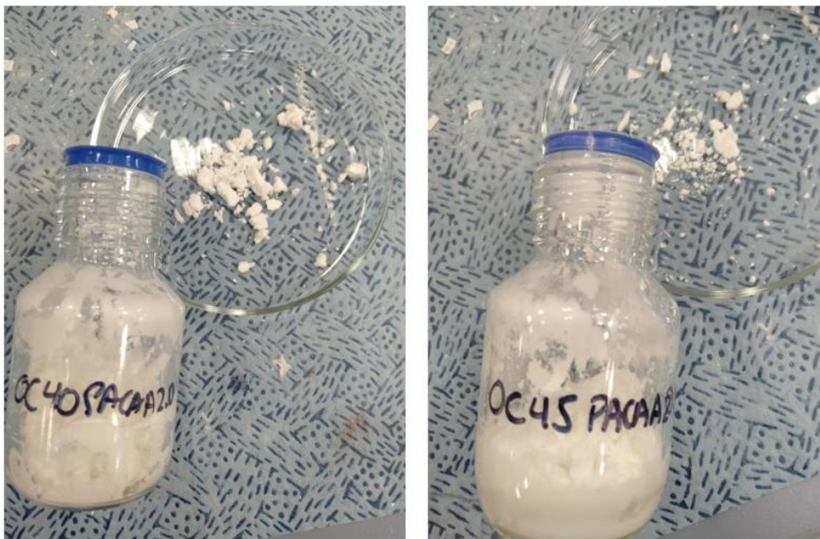
Figure 146. Photographies des suspensions d'oxalate de cérium dispersées avec PACAA à 2%, pour un taux de charge de 40 et 45% volumique respectivement.
