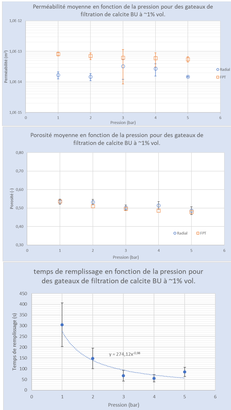
Figure 138. Evolution de la perméabilité, de la porosité mesurées dans la cellule radiale et la cellule miniaturisée FPT, et du temps de remplissage en fonction de la pression, mesurés dans la cellule radiale, pour une suspension diluée de calcite BU
