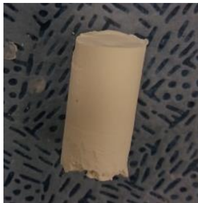
Figure 155. Gâteau de filtration de 3 cm de hauteur obtenu par remplissage complet de la membrane inox, lors du passage d'une suspension de BioUltra à 6% m
