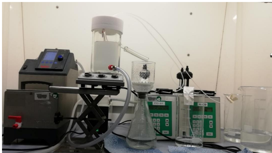
Figure 42. Photo du montage expérimental pour la précipitation d'oxalate de cérium
