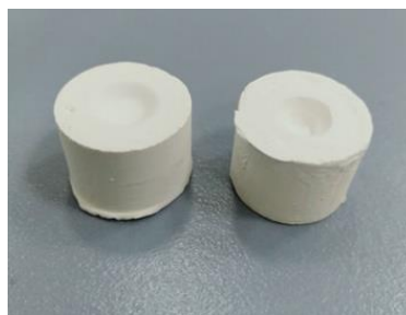
Figure 111. Photographie de deux pastilles fabriquées par la méthode de cycle de pression de la calcite BU30PACAA1.75, un orifice dans le centre de la pastille a été souvent retrouvé
