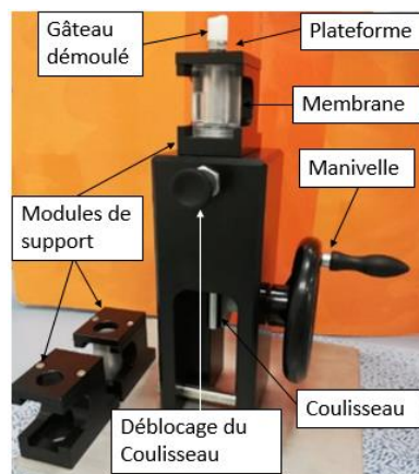
Figure 84. Description de l'outil pour le démoulage des gâteaux
