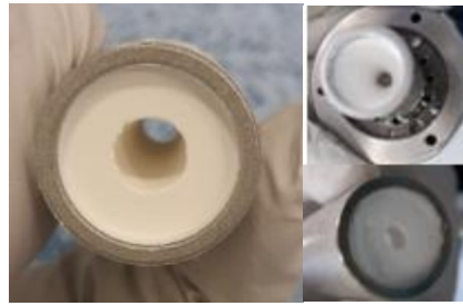
Figure 86. Observations lors du remplissage incomplet de la cellule en faisant emploi des suspensions concentrées à 2% massique : A) Un gâteau cylindrique uniforme lors du passage de la suspension de BioUltra. B) Un gâteau conique lors du passage de la suspension de BioXtra (observation au-dessus et en dessous)
