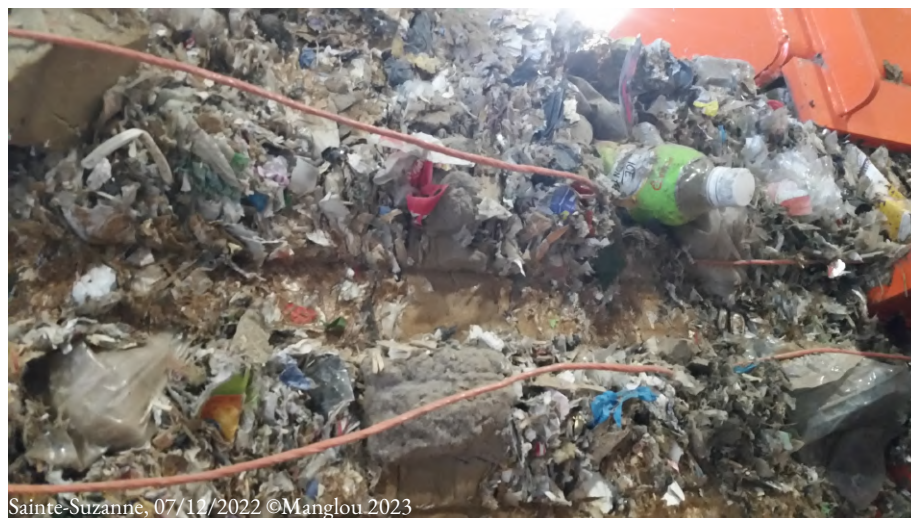
FIGURE 4.45. – Photographie d'un ballot de Combustible Solide de Récupération de près : la présence de plastiques. INOVEST, Sainte-Suzanne, La Réunion (2022)
