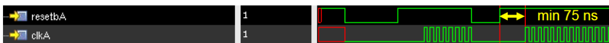
Figure 3.32: Chronogramme montrant la temporisation du redémarrage de l'horloge 40 MHz après un reset.
