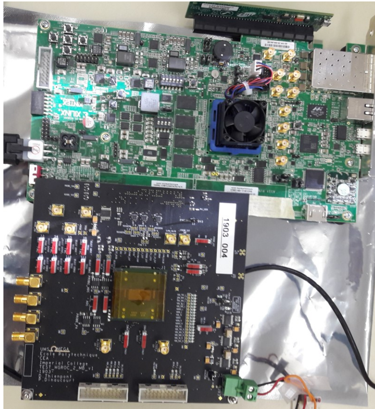
Figure 4.17: Photo du banc de test d'HGCROCV2 avec la mezzanine sur la carte « Single ROC ».
