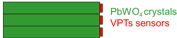
Figure 2.7: Composition d'un calorimètre électromagnétique homogène de CMS.
