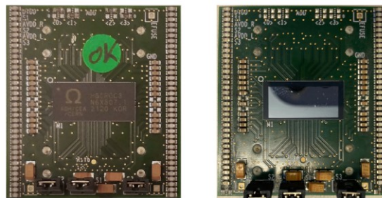
Figure 4.24: Photo de la mezzanine avec HGCROCv3 à gauche et une fois affiné à droite.
