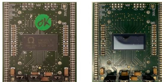
Figure 4.24: Photo de la mezzanine avec HGCROCv3 à gauche et une fois affiné à droite.
