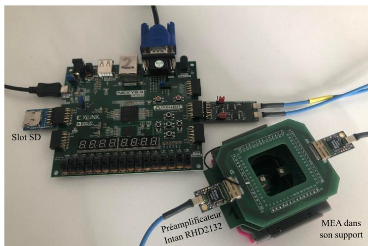
FIGURE 3.29 – Photographie du système d'acquisition d'activité électrique.
