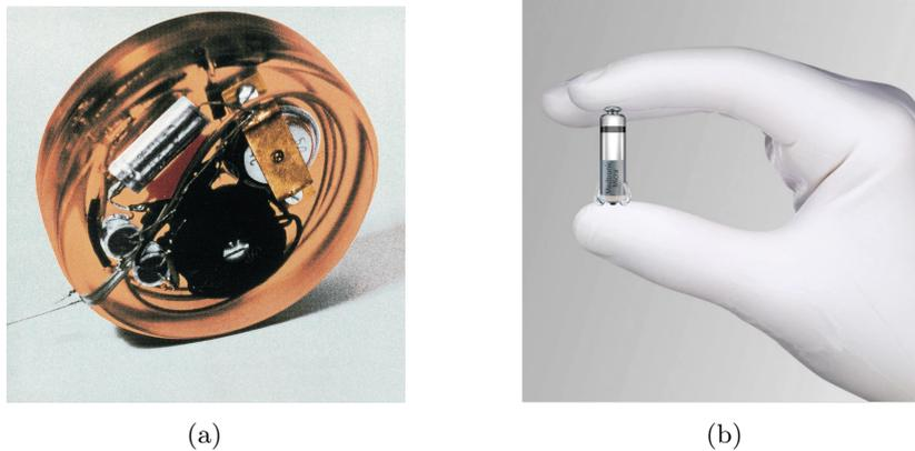
FIGURE 1.3 – (a) Photographie du premier pacemaker implanté en 1958 (6 x 2.2 cm, 170 g, image de Siemens<sup>2</sup>). (b) Photographie du plus petit pacemaker au monde, Micra™TPS, mesurant 25.9 x 6.7 mm, pour un poids de 1.75 g. Image de Medtronic<sup>3</sup>.
