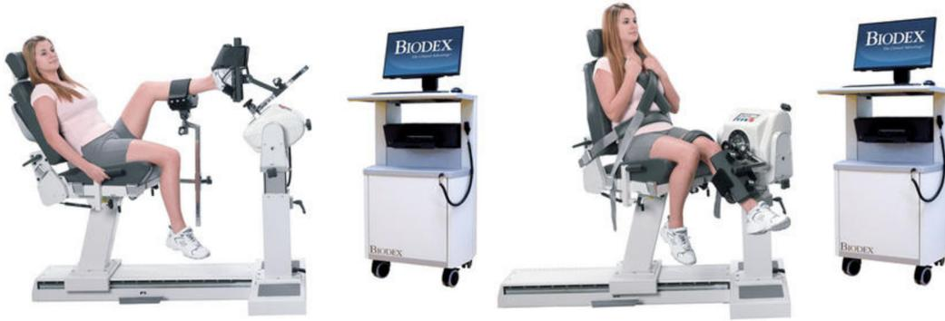
FIGURE 2.5 – Exemples d'utilisations d'un dynamomètre isocinétique (Biodex System 4<sup>4</sup>) pour la mesure de couple généré lors de mouvements de la cheville ou de la flexion du genou.
