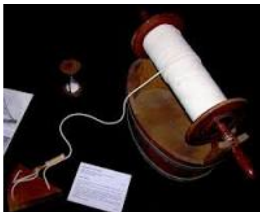
FIGURE 2.5 – Un loch à plateau, premier outil pour réaliser un dead-reckoning. La bobine est pourvue de noeuds utilisés pour mesurer la vitesse d'un navire.
