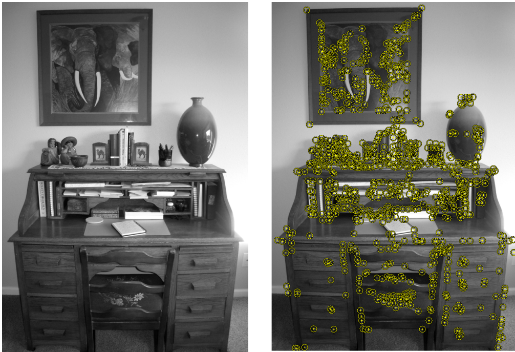
FIGURE 2.22 – Applications du détecteur de Harris à l'image de gauche. On constate la détection de nombreux coins sur l'image. Le nombre de coins détectés dépend du seuil décidé par l'expérimentateur.
