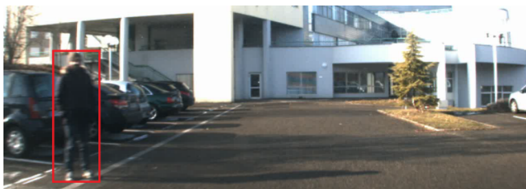
FIGURE 2.20 – Cas exemple d'une application de détection d'obstacle : un piéton est détecté et mis en évidence par une boîte l'encadrant sur l'image issue du flux vidéo.
