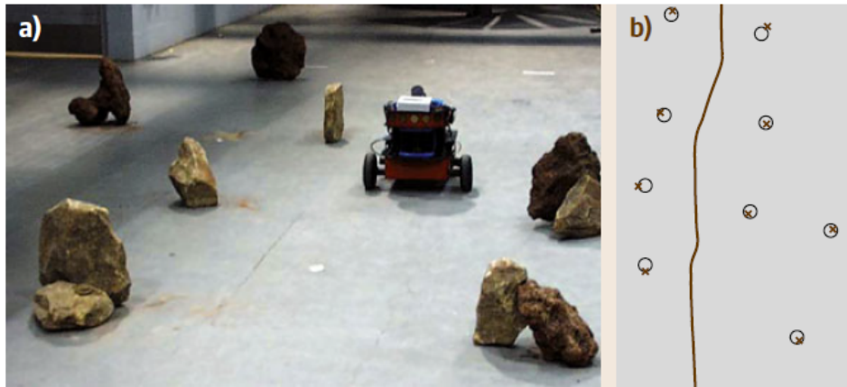
FIGURE 2.10 – Illustration de l'intérêt de la cartographie. Le robot présent sur l'image a) a défini les différents obstacles comme des amers sur sa carte en image b). Ainsi notifiées, leurs positions sont connues du robot qui pourra utiliser cette information pour sa navigation.
