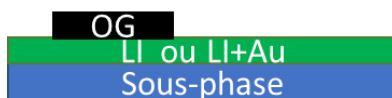
Figure 7-19 : Schéma d'un film de ([C_{20}mim]^+[NTf_2]^- + OG)_{NMP} transféré sur un substrat Si/SiO 2 pour un ratio R = 100 et une pression inférieure à la pression de collapse.
