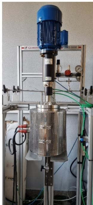
Figure 25 : Autoclave de 8 L utilisé pour la synthèse à grande échelle de HKUST-1.
