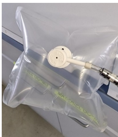
Figure 35 : Photo d'une poche à gaz (sac Tedlar®) de 500 ml utilisée pour prélever et injecter un échantillon de gaz dans la GC-MS.
