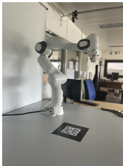
FIGURE 1.3 – Photographie d'un robot collaboratif Panda fabriqué par l'entreprise Franka Emika.
