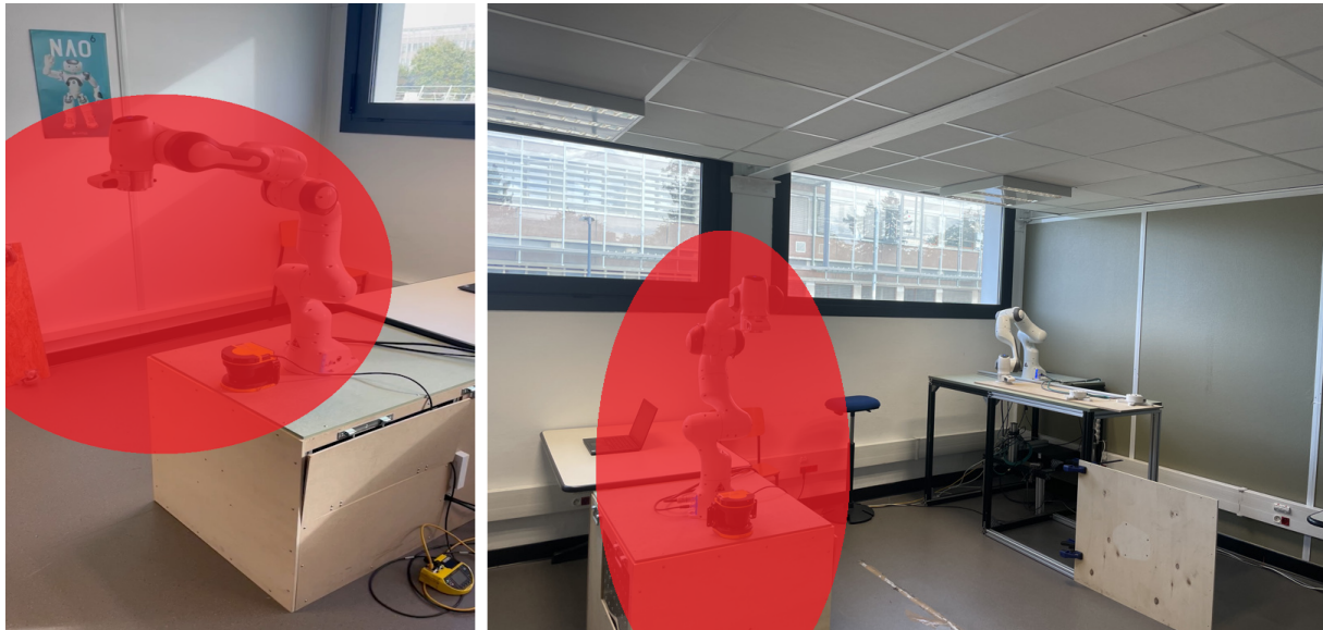
FIGURE 3.7 – Représentation de la zone de danger du Cobot 2.
