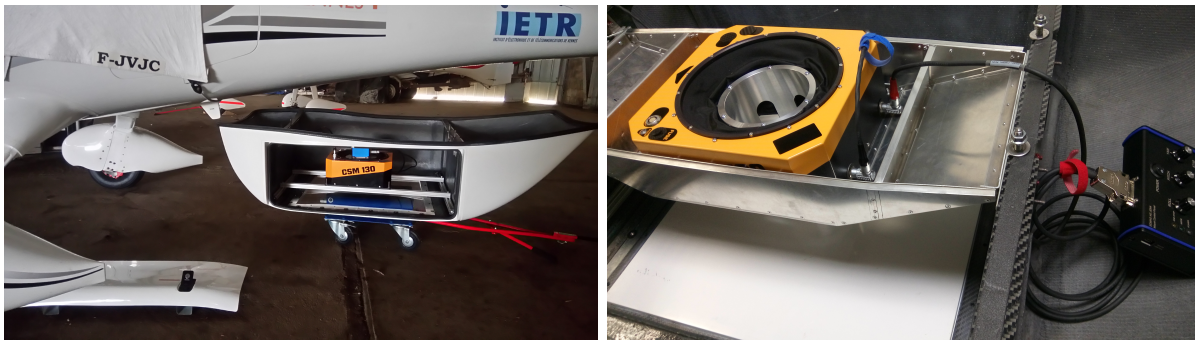
FIGURE 2.27 – Installation de la nacelle SOMAG CSM130 dans le cargo-pod
