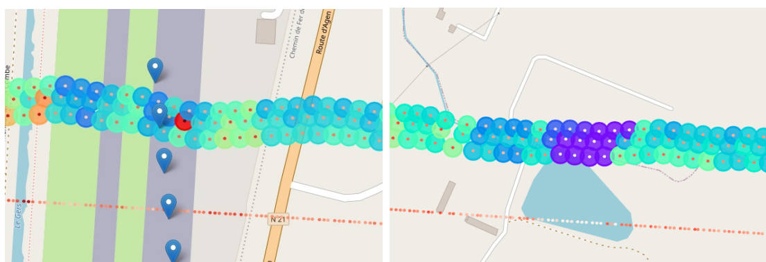
FIGURE 4.7 – Extrait des puissances rétrodiffusées (rétrodiffusion vers le radar importante en rouge et rétrodiffusion vers le radar très faible en violet) lors du vol au-dessus de l’aérodrome de Auch (sans correction)
