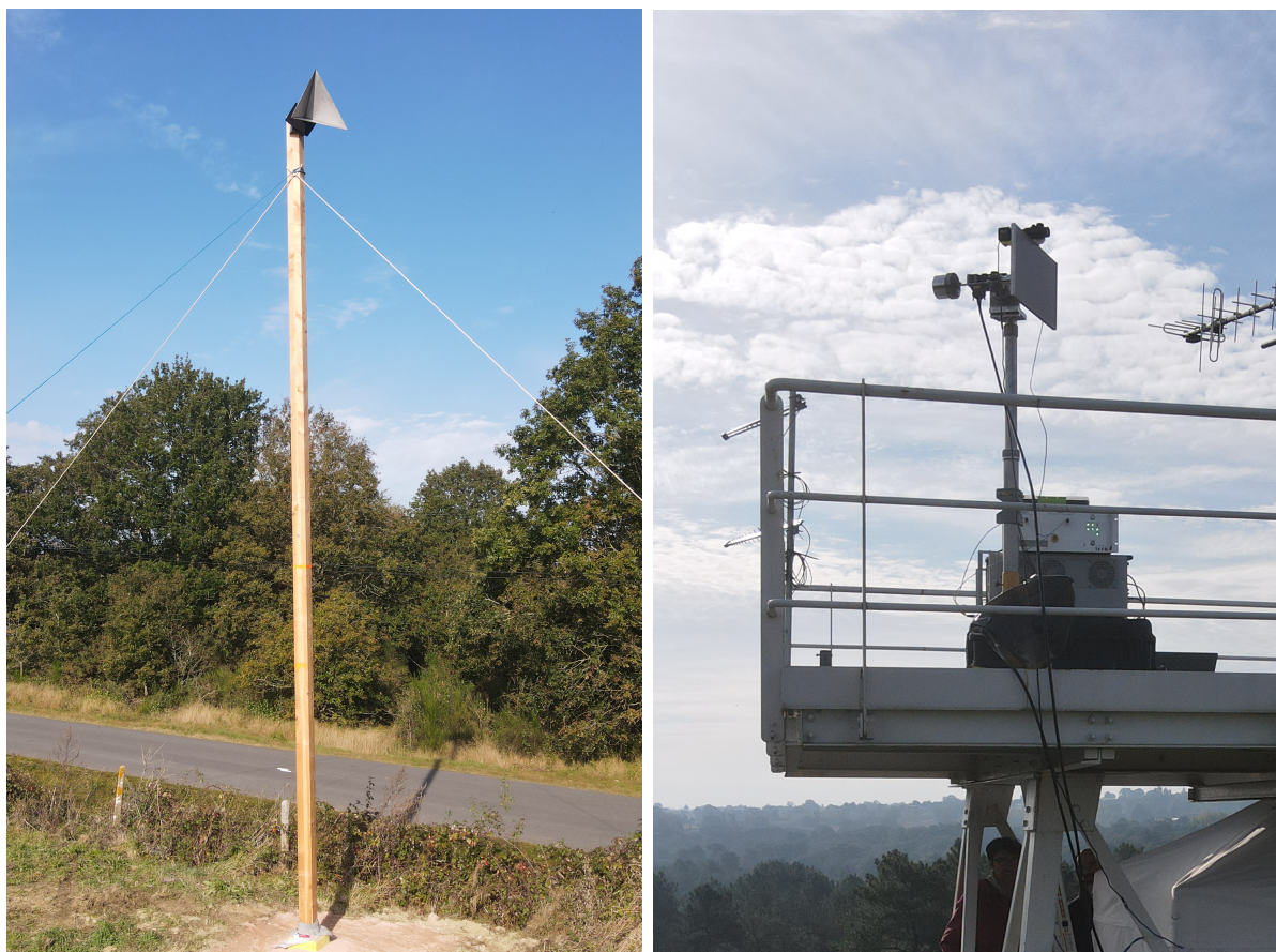
(a) Trièdre placé sur un mât (hauteur de 8 mètres). (b) Antenne radar située sur la plate-forme à 15 mètres de hauteur
