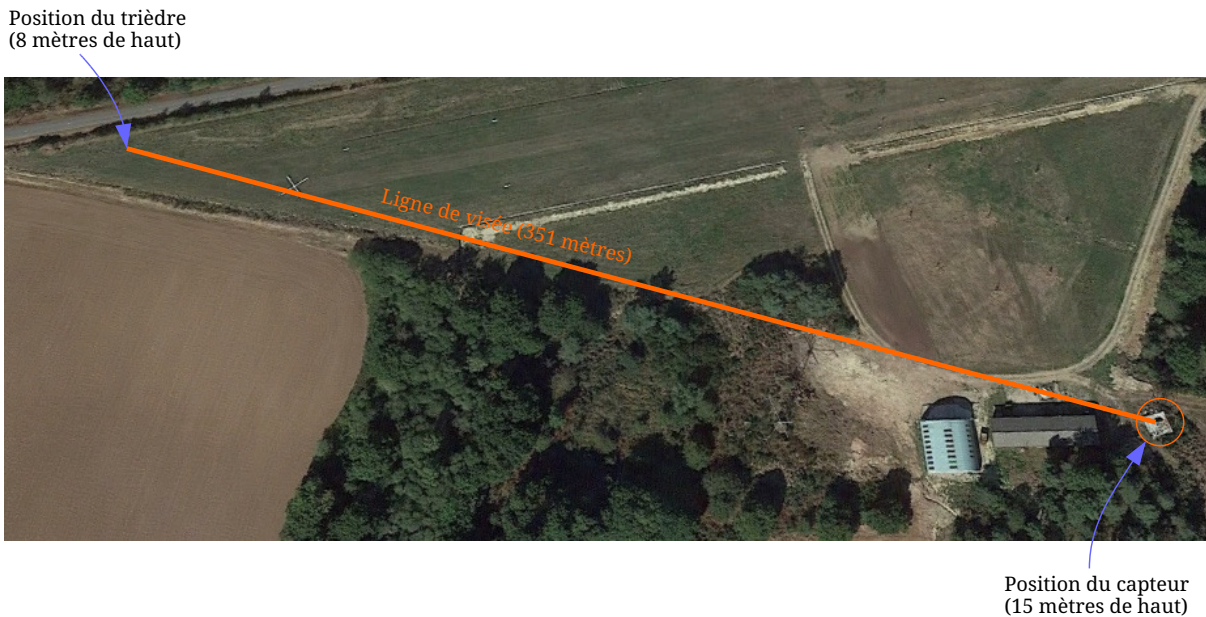
FIGURE 3.2 – Configuration géographique pour les opérations de calibration (extrait Google Earth).
