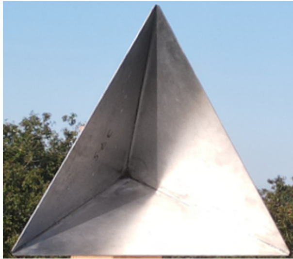
FIGURE 3.4 – Exemple d’un trièdre utilisé pour les opérations de calibration.
