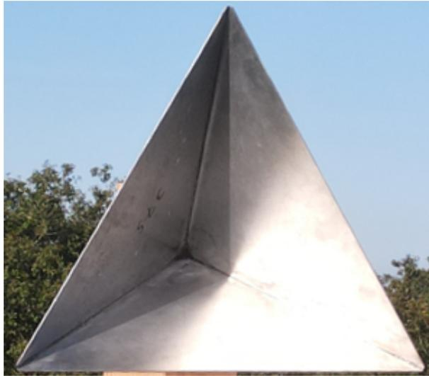
FIGURE 3.4 – Exemple d’un trièdre utilisé pour les opérations de calibration.
