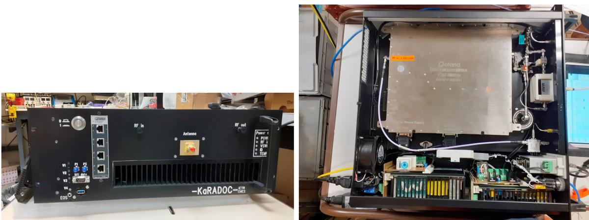
FIGURE 2.29 – Photos des vues face avant et face dessus de KaRADOC
