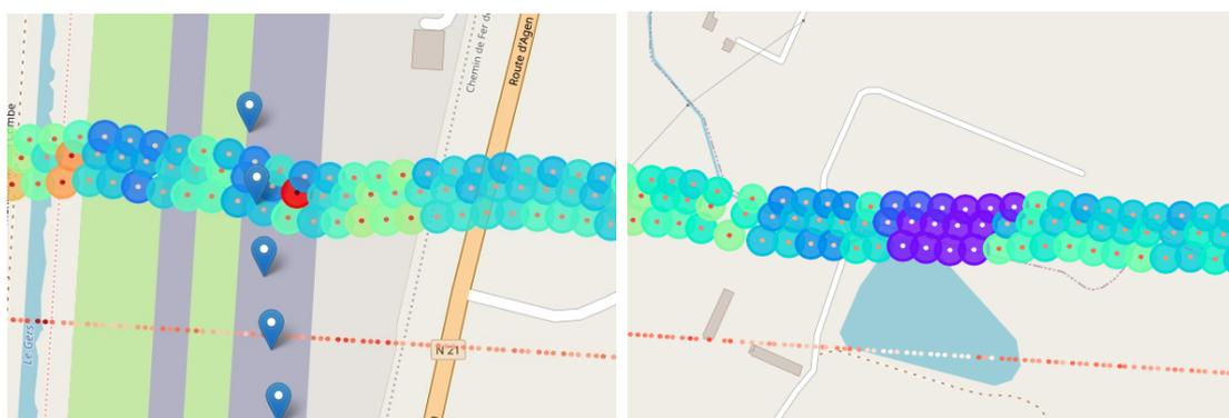
FIGURE 4.7 – Extrait des puissances rétrodiffusées (rétrodiffusion vers le radar importante en rouge et rétrodiffusion vers le radar très faible en violet) lors du vol au-dessus de l’aérodrome de Auch (sans correction)
