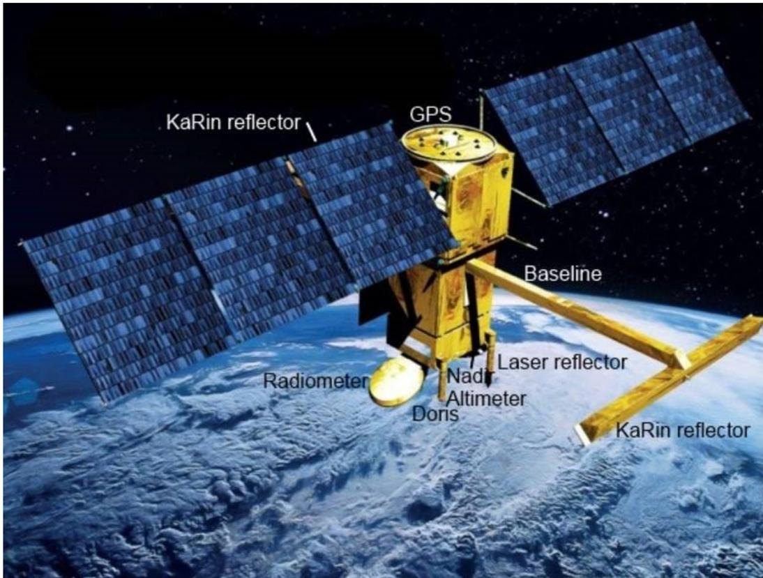
FIGURE 1.7 – Ensemble des instruments embarqués par la mission SWOT © TAS
