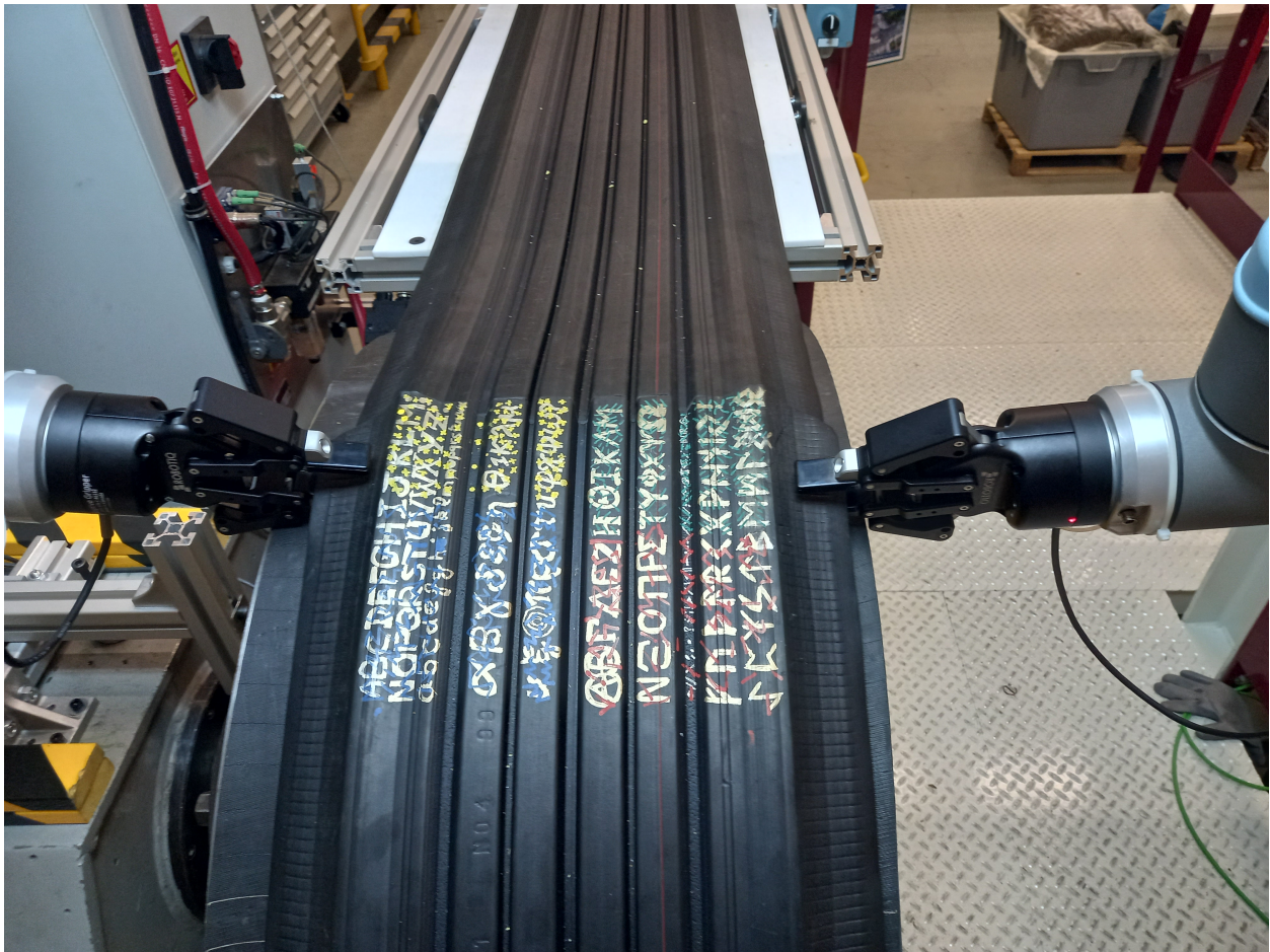
FIGURE 4.22: Tread texturé pour les tests de ROBUSfT avec contrôleur OSS sur le banc de test Michelin
