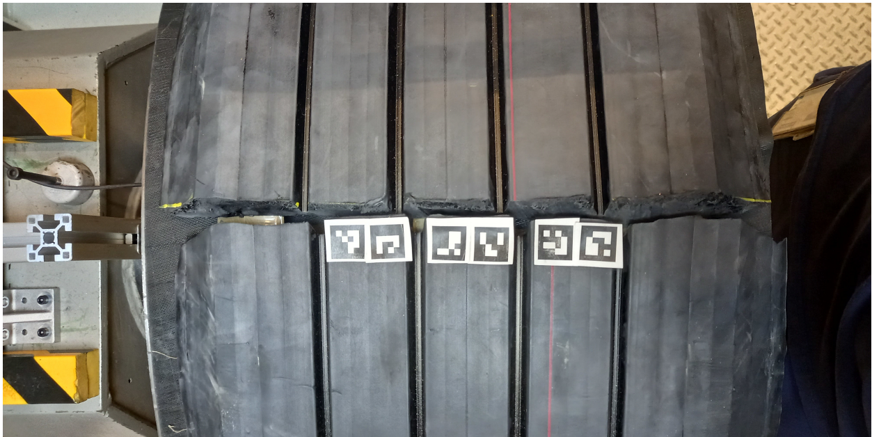
FIGURE 4.33: Bande de roulement avec marqueurs ArUco pour valider la stratégie proportionnelle spécifique
