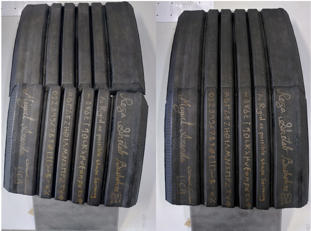
FIGURE 1.2: Erreur d'alignement initial de la gomme
