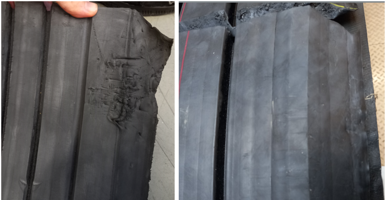
FIGURE B.4: Impact de la forme des doigts sur l'intégrité de la gomme
