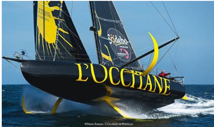
Figure I-3 : L'occitane, monocoque de 60 pieds appartenant à la classe IMOCA et dimensionné par GSea Design (@P. Bouras)
