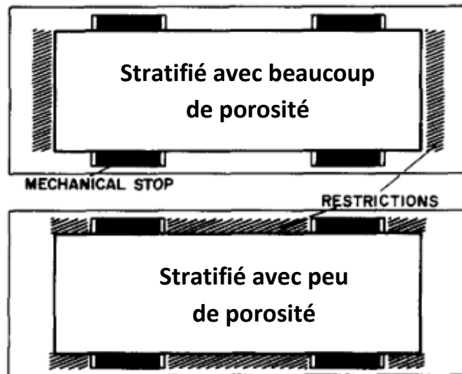
Figure I-39 : Condition aux bords des plaques lors de la cuisson (vue de dessus) (Almeida et Neto, 1994)
