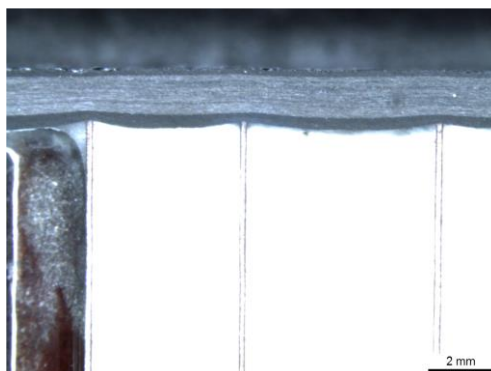
Figure IV-3 : Ondulation des plis de la peau supérieure collée sur du Nomex (télégraphiage) (Méchin, 2017)
