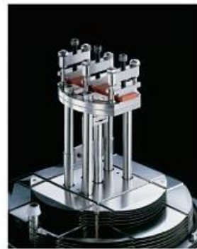
Figure 8. Montage des mors de DMTA en mode a) traction et b) single cantilever
