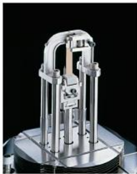
Figure 8. Montage des mors de DMTA en mode a) traction et b) single cantilever
