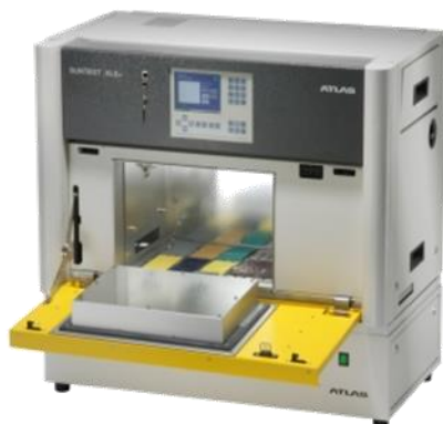
Figure 2. Image d'une enceinte XLS+ Suntest (Ametek)
