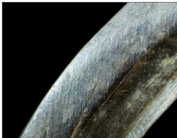
fig. 91 - Vue des stries sur la surface de l'anneau 5/301.103/13-005, x2.5
