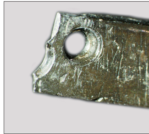
fig. 117 - Vue de la perforation abandonnée sur l'applique 6364-027, x2.5
