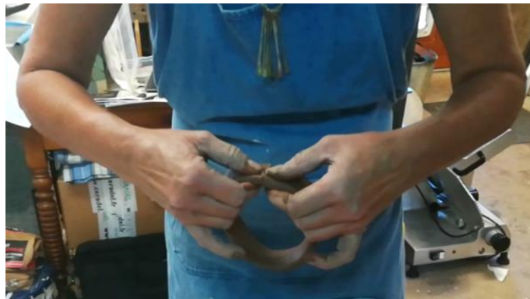
Figure 4.22. Étapes de fixation des deux parties du cadre entre elles. Application de la barbotine sur l'outil, rainurage des zones de fixation et fixation des extrémités entre elles.
