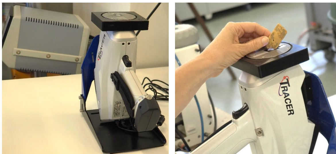
Figure 3.74. Mesure de la tranche de HCH-05 par Bruker Tracer 5i.
