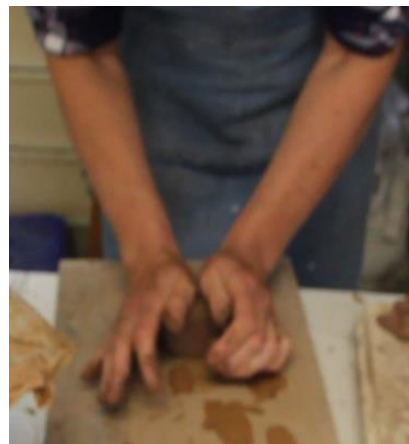
Figure 4.17. Pétrissage de l'argile en tête de bélier.
