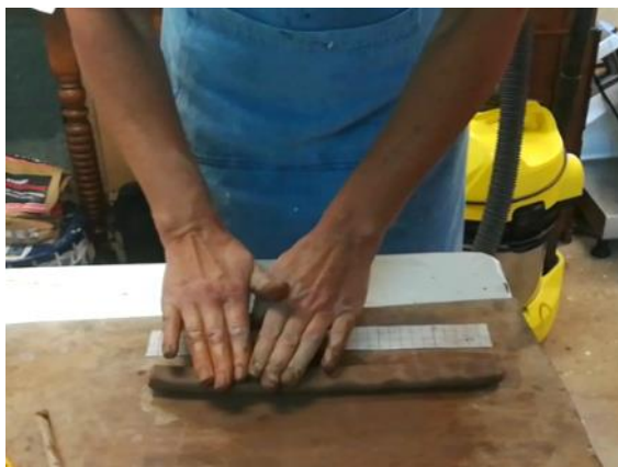
Figure 4.20. Aplatissement du colombin.
