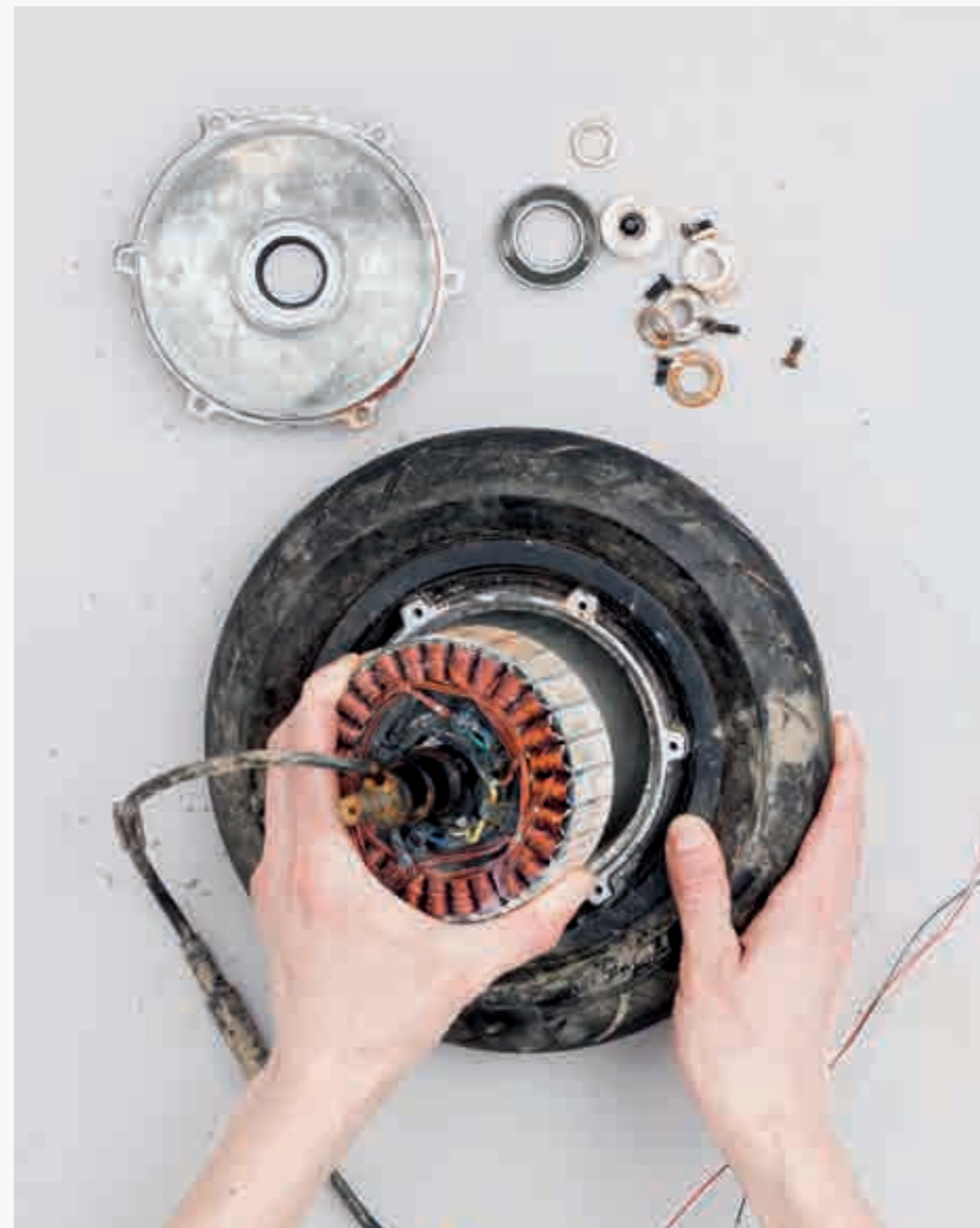
Image 5. Extraction du moteur électrique de la roue arrière.
