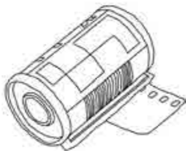
→ Code DX à la surface de la coque extérieure d'un pellicule photographique 24x36 de Kodak. Dessin à partir d'une photographie trouvée sur internet.
