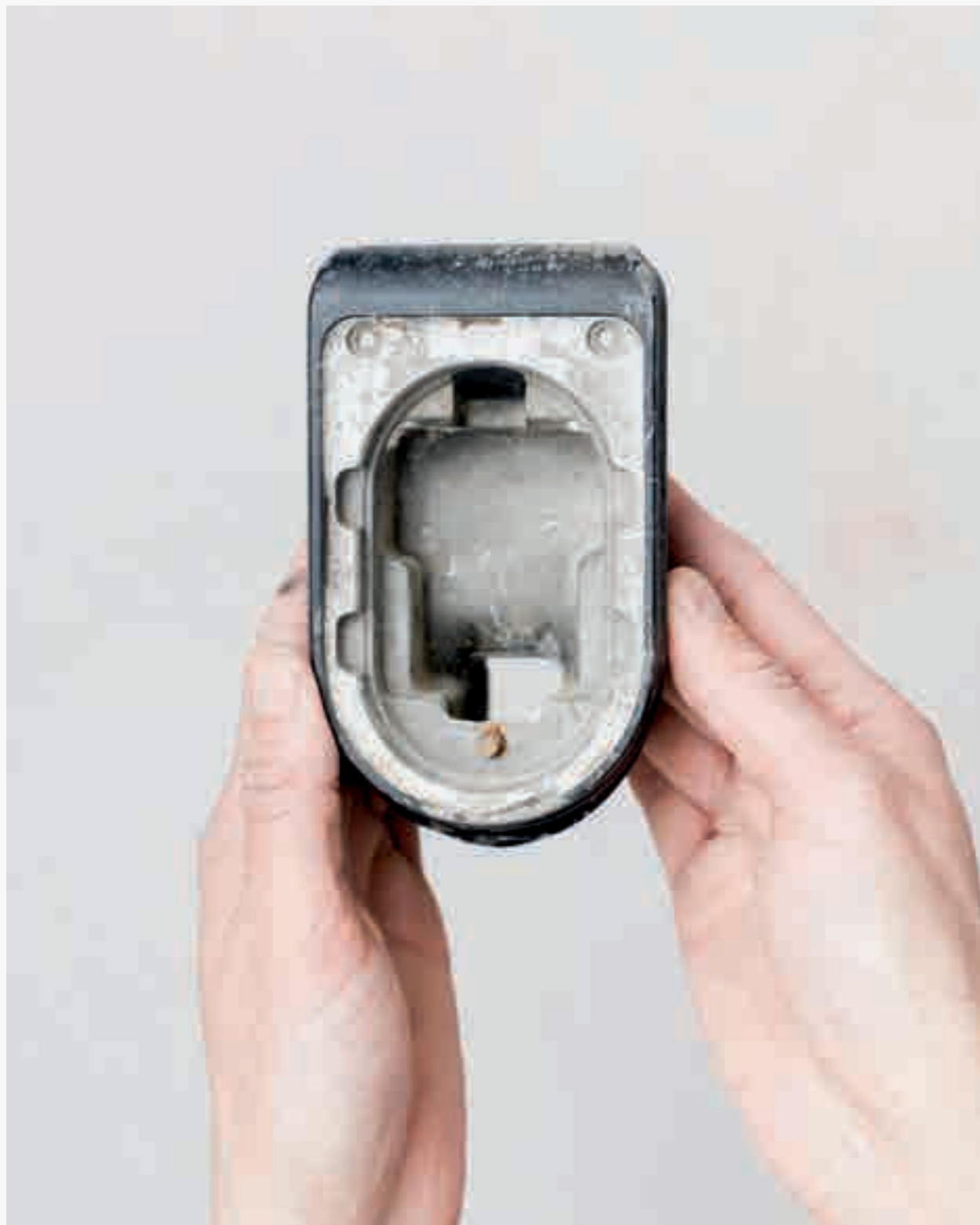
Image 9. Réceptacle du boîtier d'affichage du guidon.
