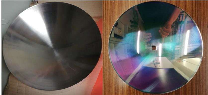
FIGURE 3.2 – Parabole non traitée (à gauche), parabole "polie miroir" avec dépôt multicouche (à droite).
