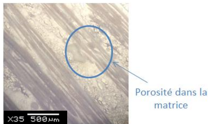
Figure 62 Vue microscopique de l'échantillon Lin/PA11
