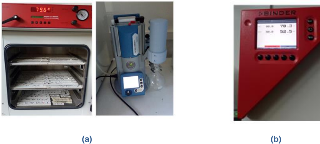
Figure 28 (a) Binder VD-115 équipée d'un groupe de pompage Vaccubrand PC3001 / (b) enceinte climatique (BINDER KMF115)
