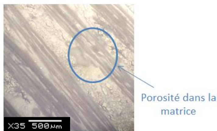
Figure 62 Vue microscopique de l'échantillon Lin/PA11
