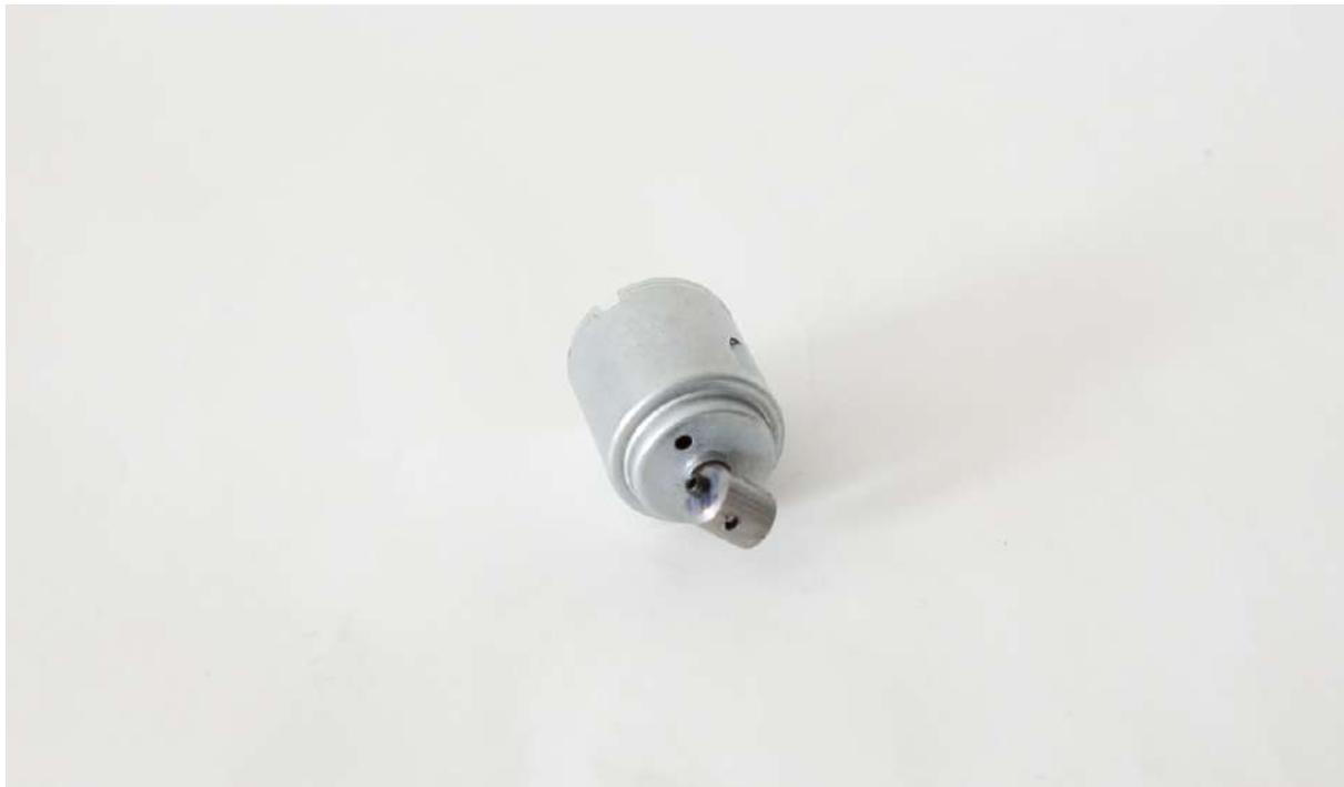
Figure 67 : Moteur sur l'axe duquel est fixé un contrepoids.
