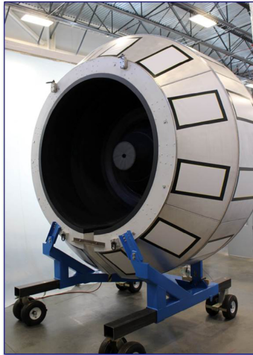
FIG. 2.5 High Threshold Cherenkov Counter entièrement assemblé. L'image originale vient de [SBB20]
