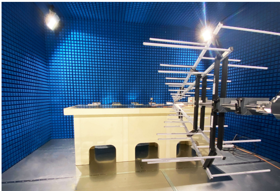
FIGURE 1.7 – Essai CEM d'un équipement sous test dans une chambre anéchoïque. Le champ EM est généré à distance avec une antenne en sortie d'un amplificateur [26].
