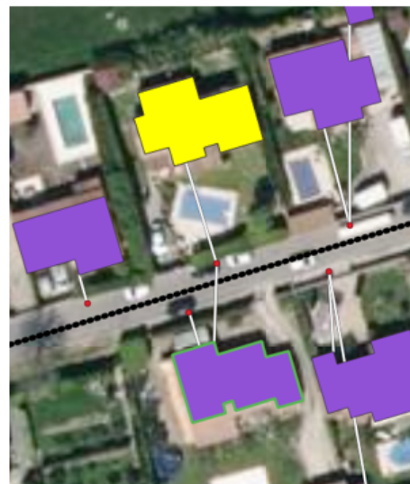
FIGURE 2.2 – Exemple de géolocalisation. Les points de géolocalisation de la BAN ne sont pas parfaits et suffisants. D'autre part, la notion de parcelle est indispensable pour le rattachement des piscines.
