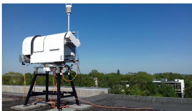
FIGURE 2.1 – Photographie du radiomètre micro-ondes opéré au LOA par O. Pujol ( olivier.pujol@univ-lille.fr ).
