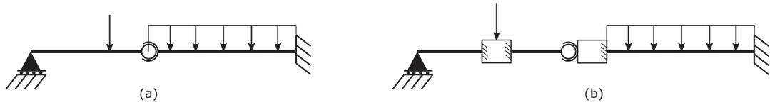
Figure 39 : Exemple de configuration avec liaison interne
