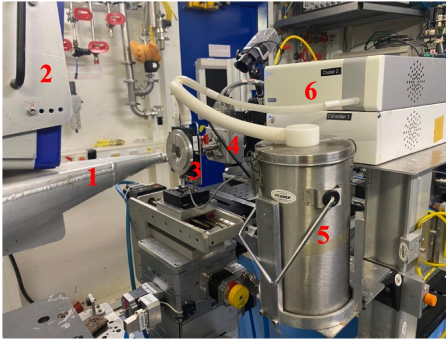
Figure 2. 7 : Couplage Linkam-WAXS (configuration WAXS-SAXS) sur la ligne BM26 au synchrotron ESRF, France avec en légende : 1) tube sous vide (pour SAXS), 2) détecteur WAXS 1D, 3) four Linkam, 4) arrivée des rayons X, 5) azote liquide, 6) système de pilotage Linkam.
