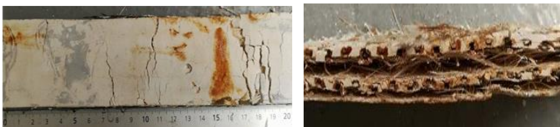
Figure IV.10 : Mode de rupture à 200°C du RC-M100 (Tlajji T. et al, 2017)
