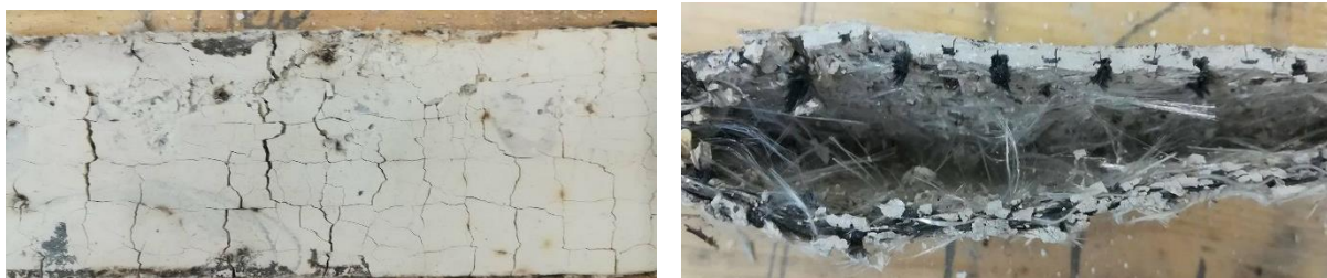
Figure IV.11 : Mode de rupture à 400°C du RC-M100 (Tlajji T. et al, 2017)
