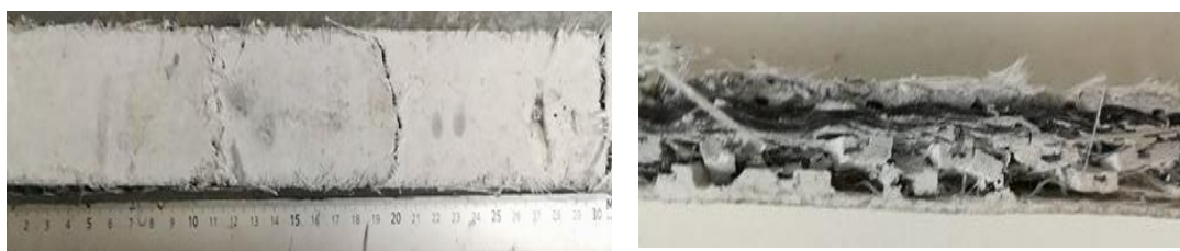
Figure IV.9 : Mode de rupture à 120°C du RC-M100 (Tlajji T. et al, 2017)
