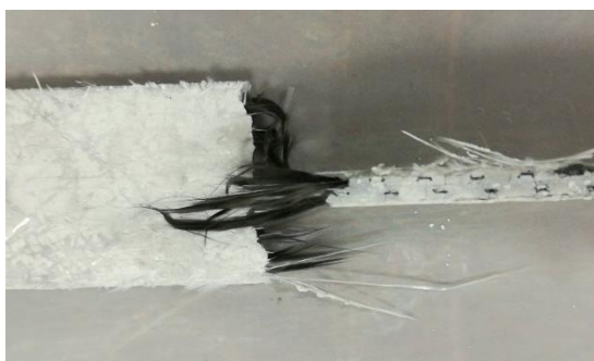
Figure IV.12 : Mode de rupture à 600°C du RC-M100 (Tlajji T. et al, 2017)
