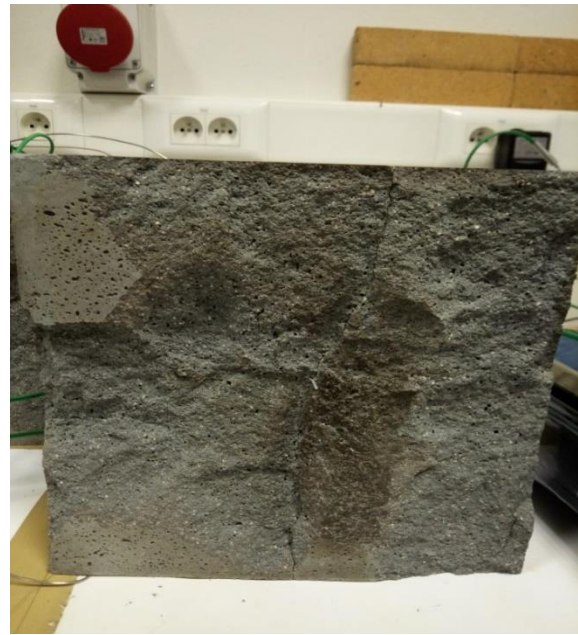
Faciès de rupture Essai 3
