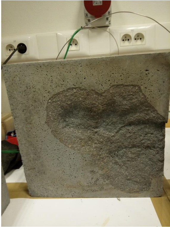
Faciès de rupture Essai 2
