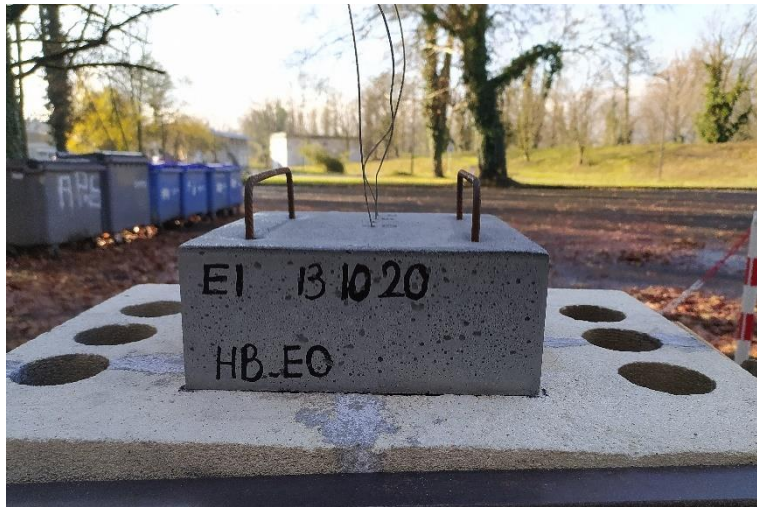
Fig.II.4 : Vue de face du four côté hublot où l'on peut voir l'éprouvette disposée sur sa face supérieure en face du trou central ; et les trous circulaires aux extrémités de la plaque supérieure du four qui servent à l'évacuation des gaz chauds.
