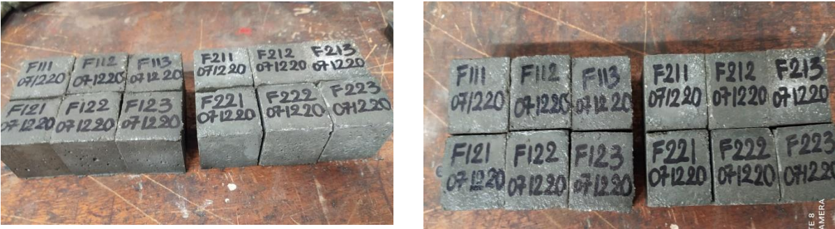
Fig.II.13 : Photos des éprouvettes cubiques de compression simple et prismatiques de flexion trois points dans les moules et en cours de démoulage.
