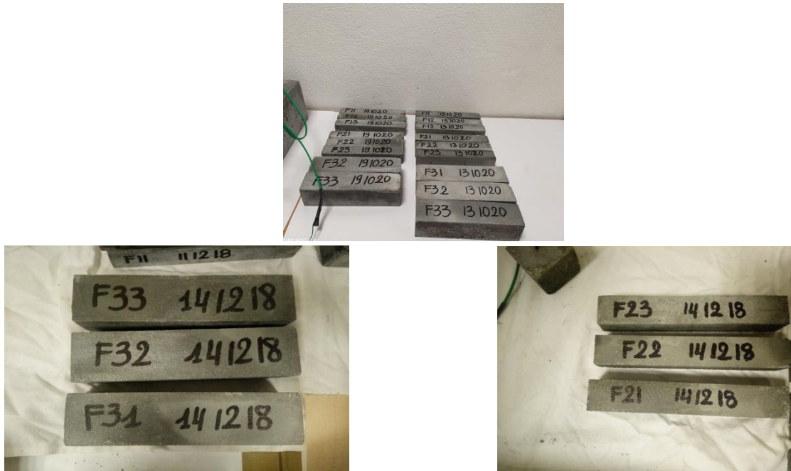
Eprouvettes de flexion : 160x40x40 (mm)
