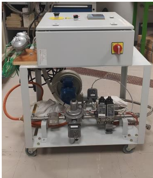
Fig.II.5 : Photo montrant l'ensemble roulant comportant le pupitre de commande du brûleur disposé sur la partie supérieure et la machinerie pour l'alimentation du brûleur en propane et en air sur la partie inférieure.
