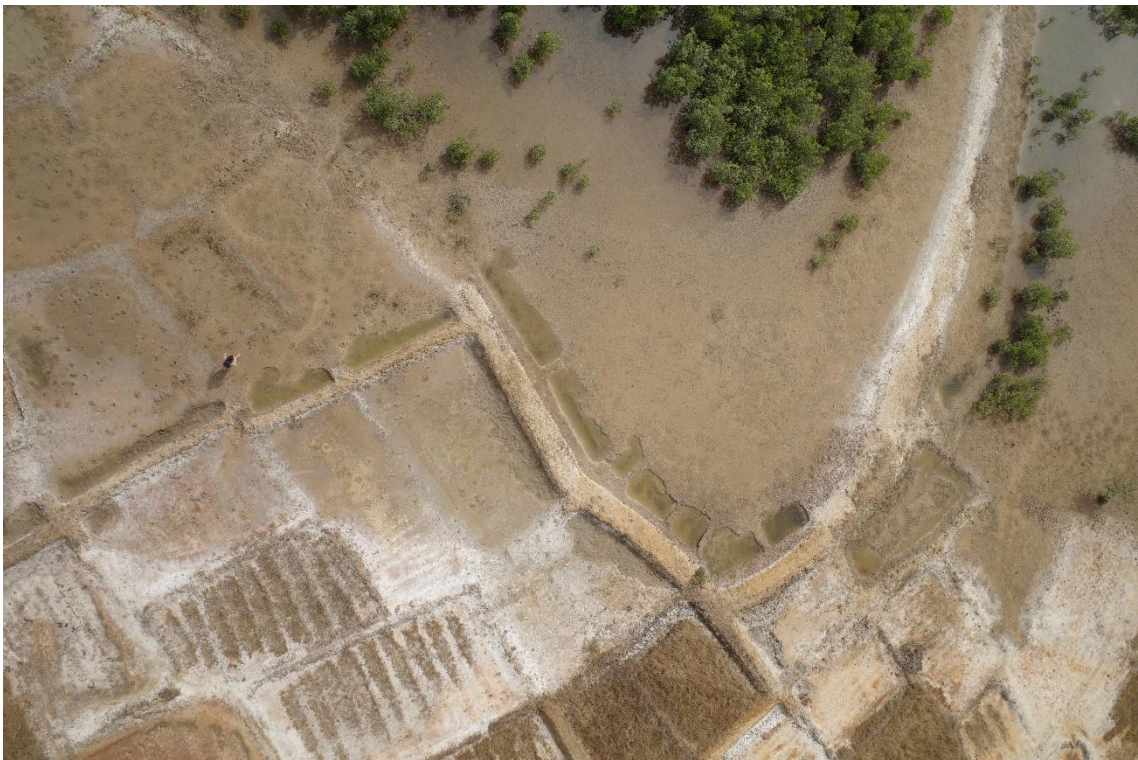
Figure 35. Vue aérienne d'un ensemble de parcelles dégradées (salinisées) en arrière de digues partiellement détruites. Djivente, 2020.
