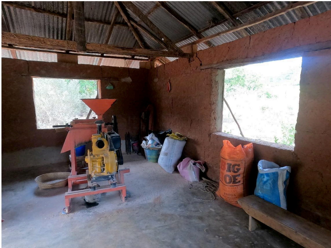
Figure 27. Décortiqueuse à essence d'Ediougou (2022). Le travail consiste, pour l'opérateur ou l'opératrice de la machine, à réceptionner les sacs de riz entier amenés par les cultivateurs et cultivatrices, à les peser, à les faire passer dans la machine, à remettre le riz décortiqué en sac d'un côté, et le son de riz de l'autre et à facturer le service. La machine est extrêmement bruyante et produit une grande quantité de poussière, ce qui rend le travail quotidien particulièrement difficile.
