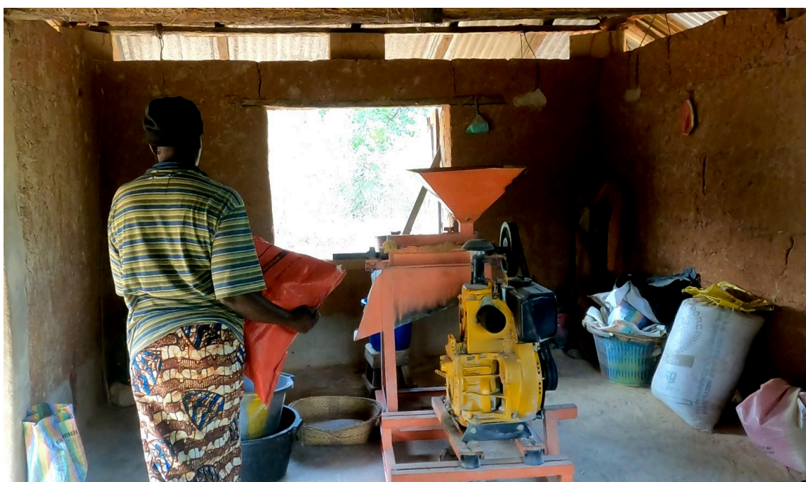
Figure 99. Une fois le riz décortiqué par la décortiqueuse (au centre), il sera rendu à sa propriétaire dans un sac tissé qu'elle aura fourni, du type de celui que Marie-Pierre a dans les mains. Au fond à droite, d'autres sacs sont utilisés pour stocker le son du riz, que la machine évacue. Edioungou, 2022.
