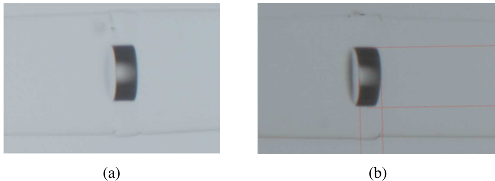
Figure III-13 : Image au microscope de la cavité Fabry-Pérot cylindrique. (a) échantillon 1 et (b) échantillon 6.
