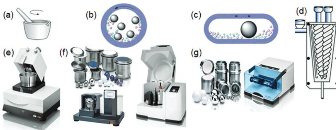
Figure 1. 5 : Schémas de systèmes de broyage mécanique : (a) mortier et pilon, (b) broyeur planétaire, (c) agitateur et (d) extrudeuse. Images des instruments de synthèse mécano chimique : (e) broyeur à mortier, (f) broyeurs planétaires et (g) broyeur-mélangeur avec équipement de broyage (jars et billes). [15]
