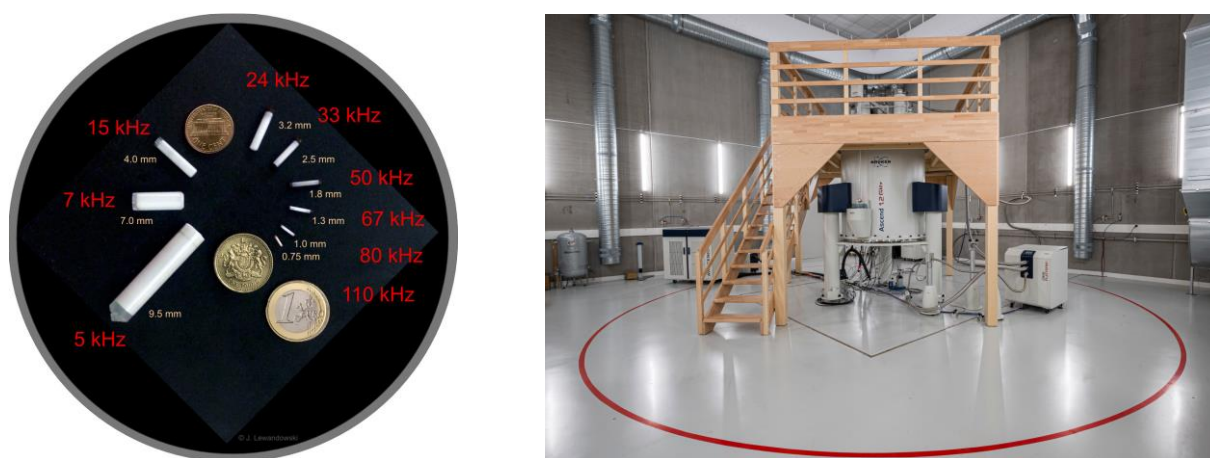
Figure 2. 10 : Image des différentes tailles de rotors et de leur fréquence de rotation correspondante. [9] (gauche) et photographie du 1.2 GHz (28,2 T) de Lille [10].
