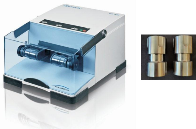
Figure 3. 1 : Photographies du broyeur Retsch MM400 et des jars en acier inoxydables. [3]
