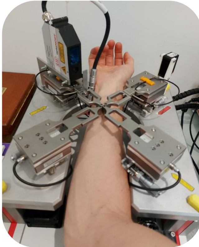
Figure C.1: Photo de la configuration de l'instrumentation en mode "in vivo" avec l'avant-bras d'un patient volontaire.
