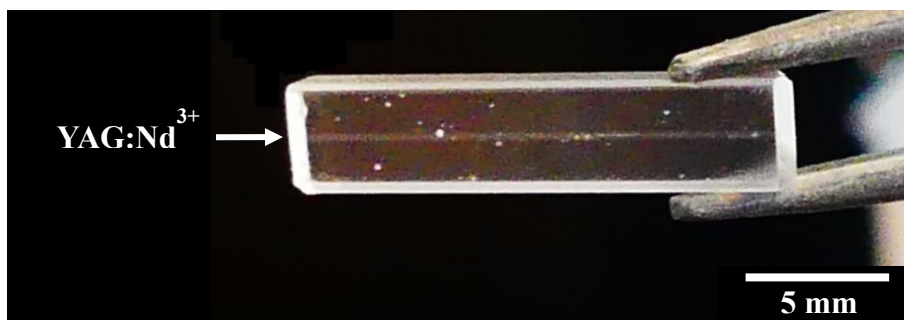
Figure 107. Photographie d'une coupe du composite élaboré sans calcination de l'alumine avant mise en suspension.
