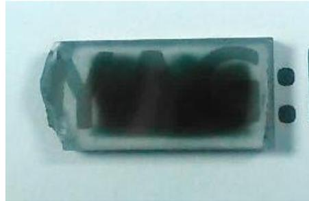
Figure 53. Photographie d'un échantillon traité par HIP puis partiellement réoxydé.
