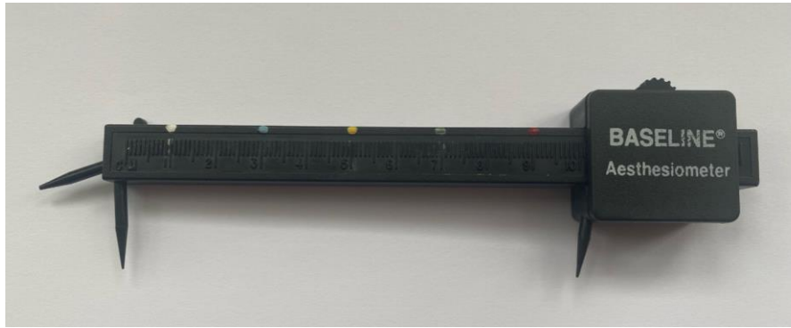
Figure 17 : exemple de matériel pour le test de discrimination des deux points, extrait de (Coggins et al., 2023).
