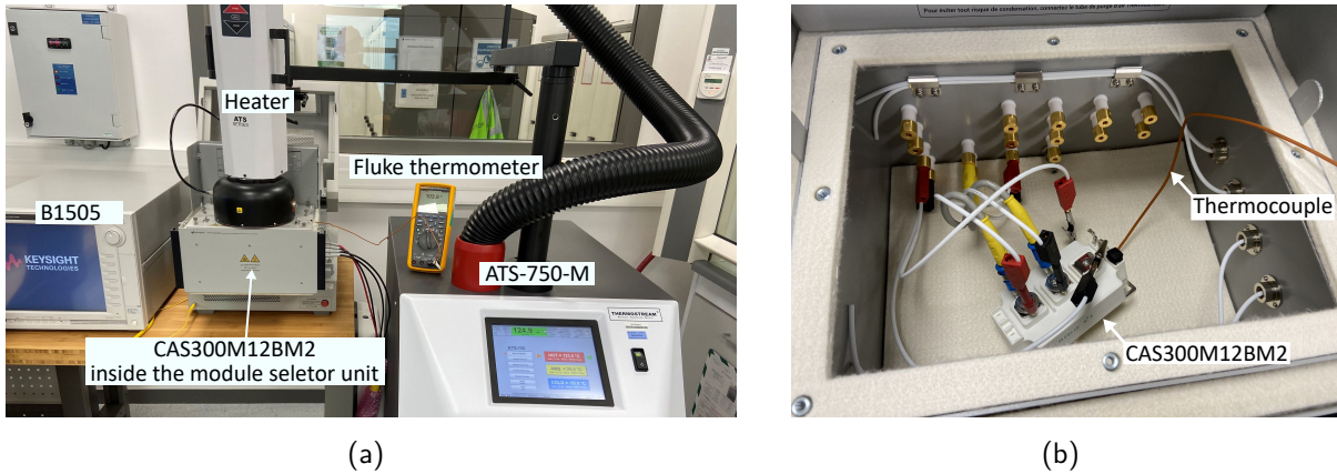
Fig. 3.21 : (a) Plateforme expérimentale chez SAFRAN Tech pour la caractérisation hors tension du module CAS300M12BM2 (b) vue interne du module selector unit
