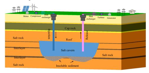
Fig. 1.1 Schéma de la centrale électrique à stockage de gaz sous pression de Salt Cave
