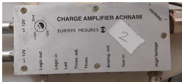
FIGURE 3.10 – Photographie d'un préamplificateur ACH-NA98.
