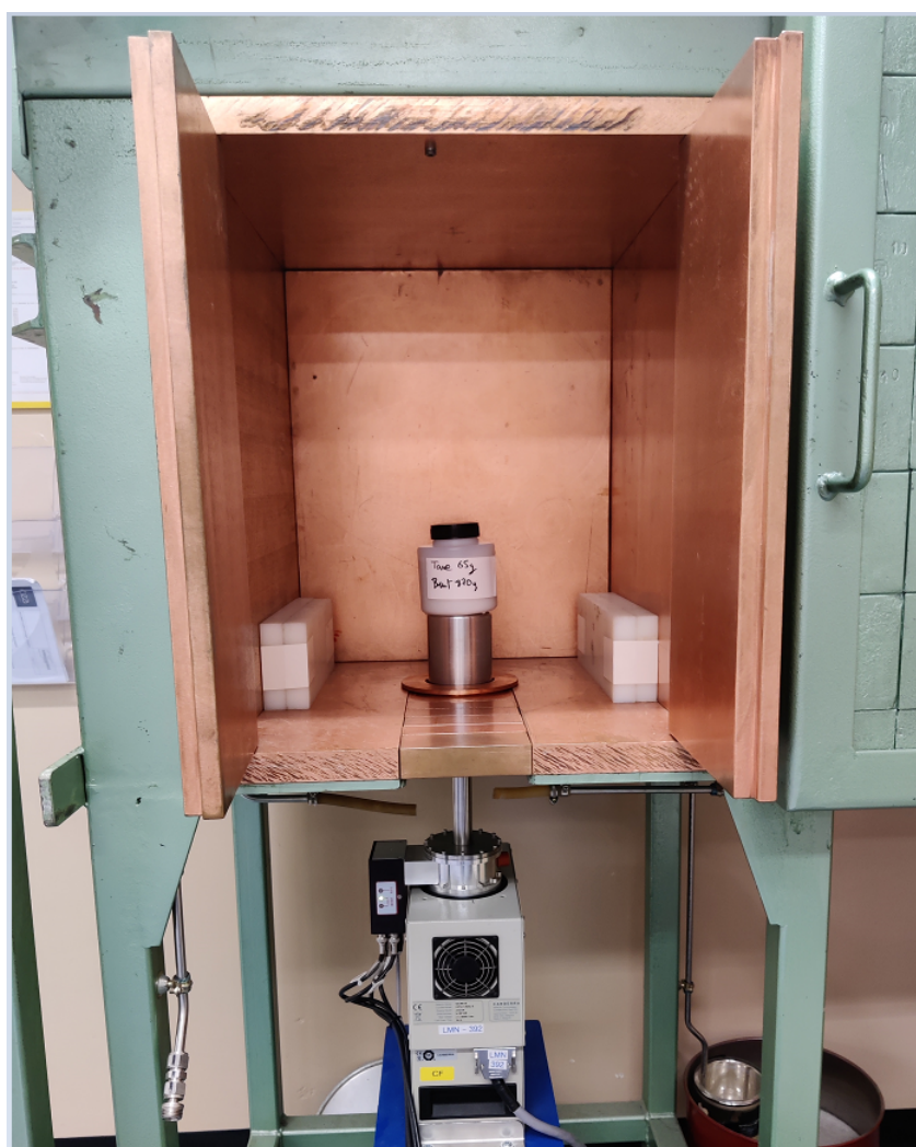
FIGURE A.12 – Photographie de l'enceinte de mesure de spectrométrie \gamma bas bruit de fond.
