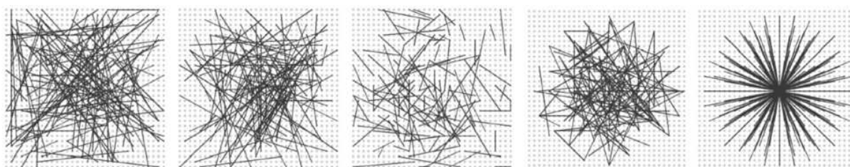
FIGURE 1.17 – Représentation des cinq approches pour choisir les paires d’emplacements sélectionnés. Ces exemples montrent 128 tests dans chaque image.
