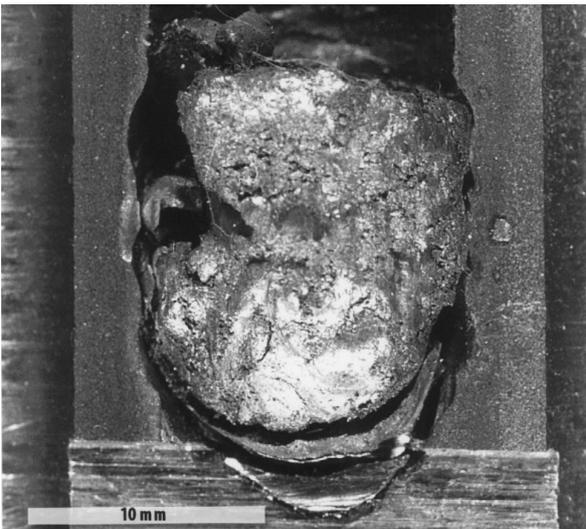
(c) Projectile en alliage de tungstène sur une cible en acier.
