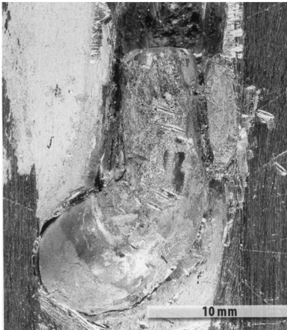
(a) Projectile en alliage de tungstène sur une cible en aluminium.
