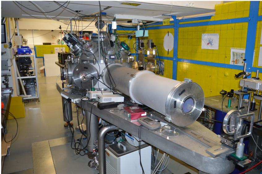
(a) Chambre d'expérience d'HERA avec ici une rallonge pour que le faisceau laser soit moins focalisé au moment de traverser le hublot et ainsi diminuer les risques de l'endommager.
