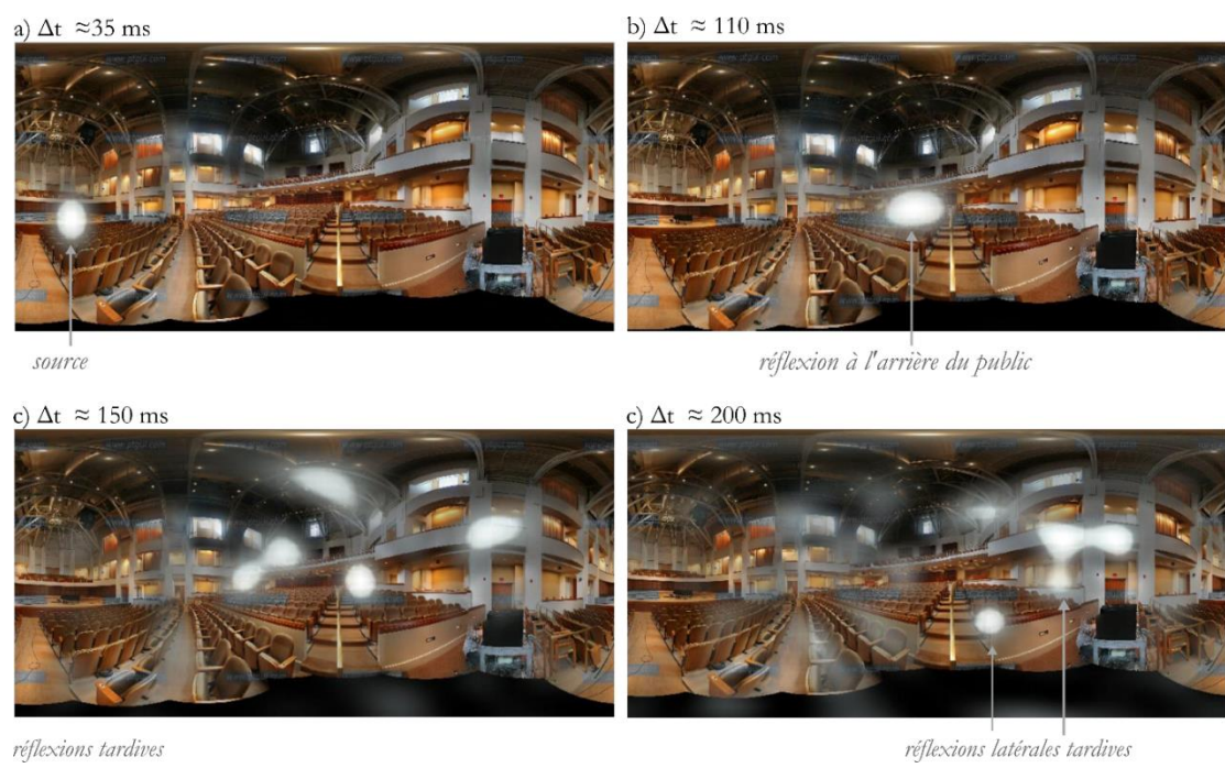
Figure 8: Identification des réflexions sonores à l'intérieur d'une salle de concert (d'après O'Donovan (2008)).
