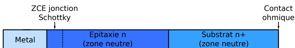
Figure 3.5 – Structure d'une diode Schottky en une dimension
