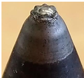
Figure I.3 : Érosion d'une cathode tige de torche à plasma d'arc [18].
